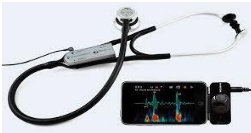
Figure II.2: stéthoscope électronique à traitement du signal
