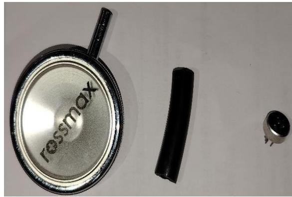
Figure III. 2: Les éléments nécessaires pour le capteur des bruits cardiaques
