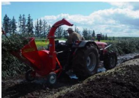
***Figure N°10*** : Broyeur du bois de taille
