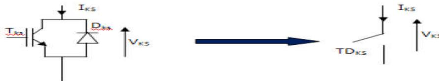
Fig.(II-1-a): Interrupteur bidirectionnel équivalent de la paire Transistor – diode
