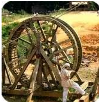
Figure I.4 photo d'une grue à cage d'écureuil.
