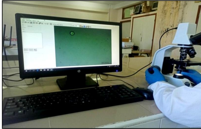
Figure 29 : Microscope optique munie d'une caméra lié à un ordinateur lié du logiciel nommé « Optika vision lite 2.1 ».
