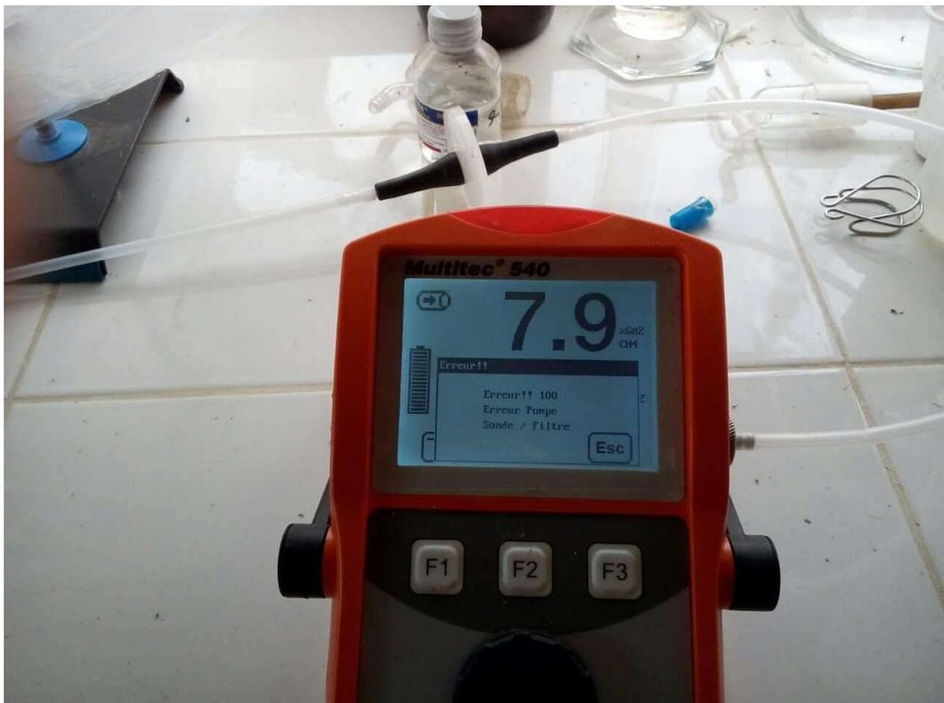
Figure n°III.21: Multi-analyseur de gaz
