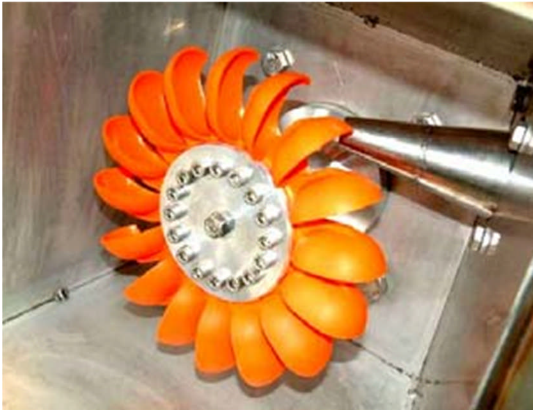
Figure 2.4 : Roue d'une turbine Turgo
