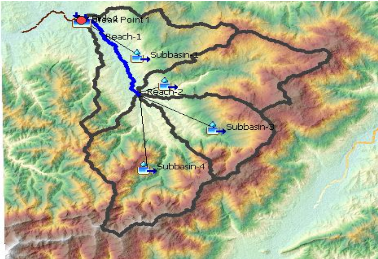
Figure 03 : Délimitation HEC-HMS du bassin de la station de Bourboune (021513).
