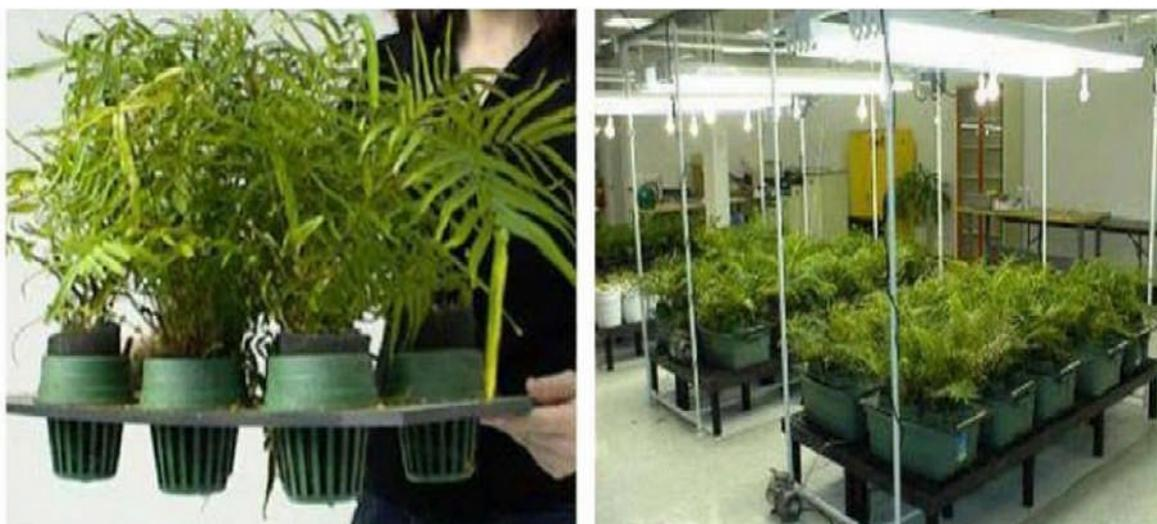
Figure 5: Processus de Rhizofiltration de l'arsenic avec des fougères (Elles et *al.*, 2005)
