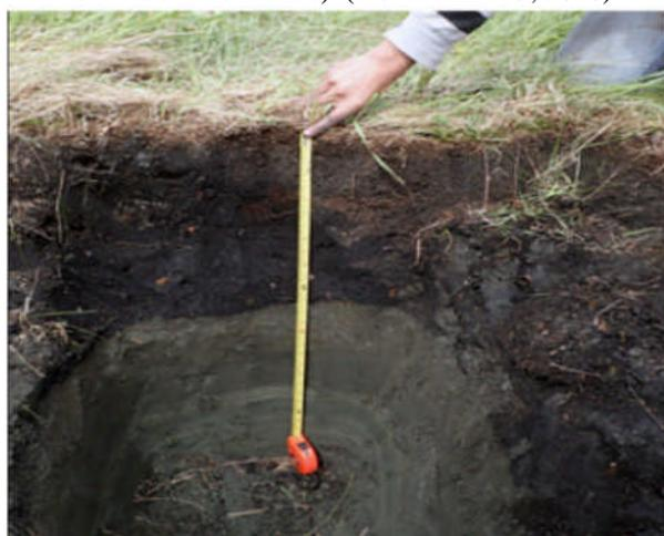
**Figure 8:** Phénomène de podzolisation, sous le couvert végétal, assurant une phytostabilisation avancée d'anciens résidus miniers impropres à la vie. (BORDELEAU, 2016)
