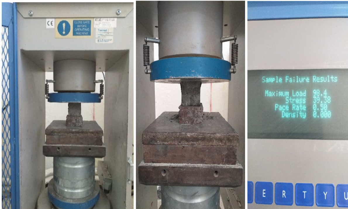
Figure IV-7 : Le presse hydraulique Ibertest de l'essai mécanique de Compression au niveau du laboratoire béton-UMMTO
