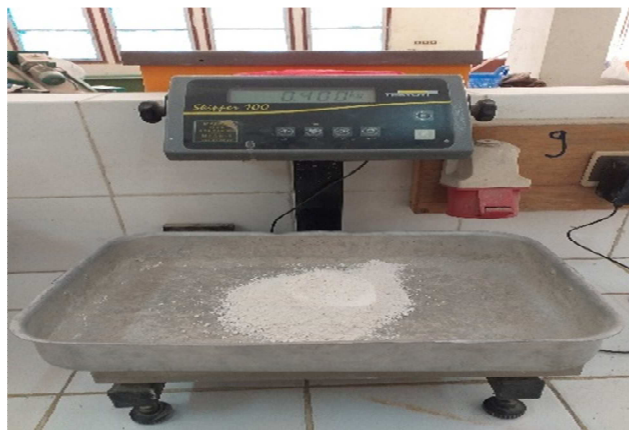
Figure III.10 : Masse volumique absolue définie au niveau du laboratoire béton-UMMTO
