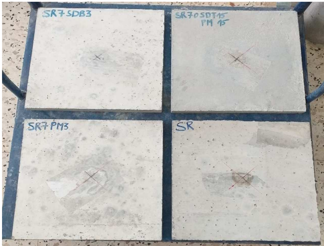
Figure III- 17 : Dalles mises à l'air libre 24h avant essais
