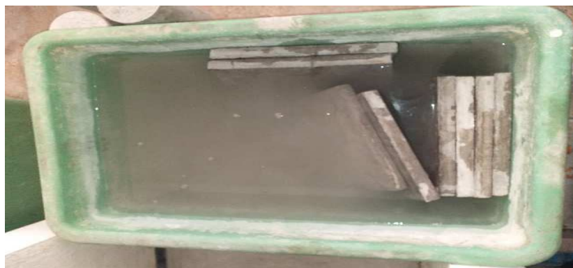
Figure III-16 : dalles démoulées et émergées dans l'eau
