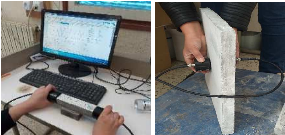
Figure IV- 2 : Essais ultrason sur les éprouvettes au niveau [Laboratoire de Béton-Génie Civil-UMMTO]
