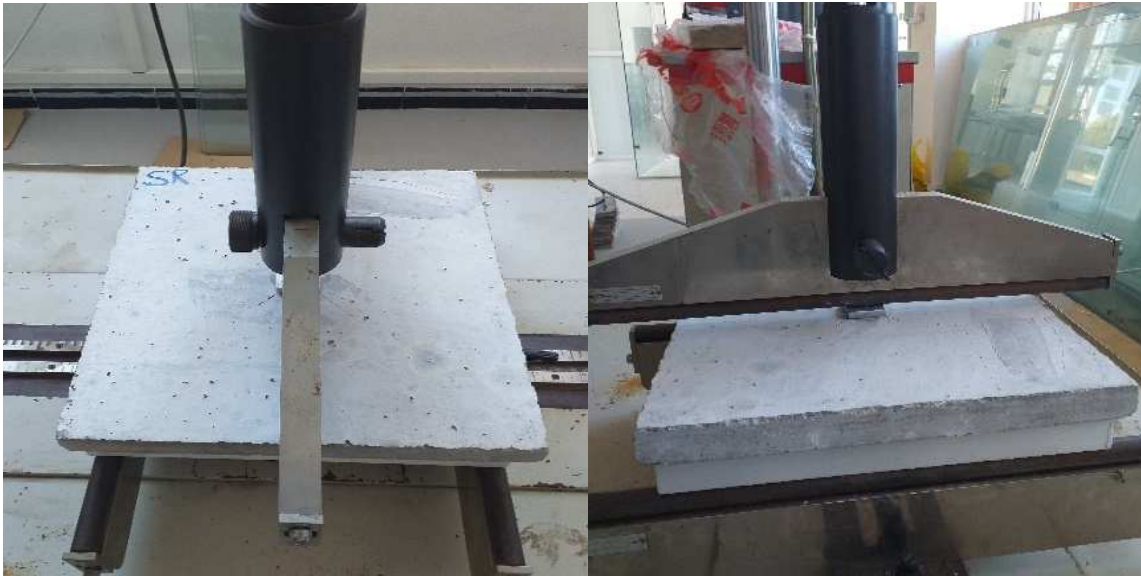
Figure IV- 22 : Dalle subie un essai de poinçonnement au niveau de Laboratoire [UR-MPE/FSI-Boumerdes]
