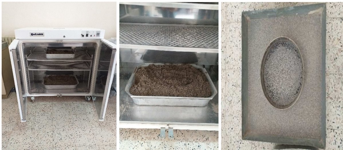
Figure III-1 : Sable de rivière tamisé (0/2) après avoir été lavé et séché à l'étuve.au niveau du laboratoire béton-UMMTO
