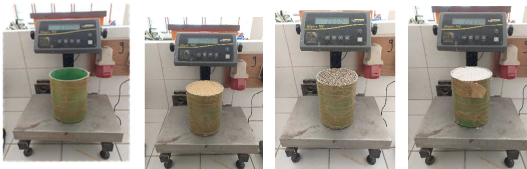
Figure III-9 : Masse volumique apparente mesurée au niveau du laboratoire béton-UMMTO
