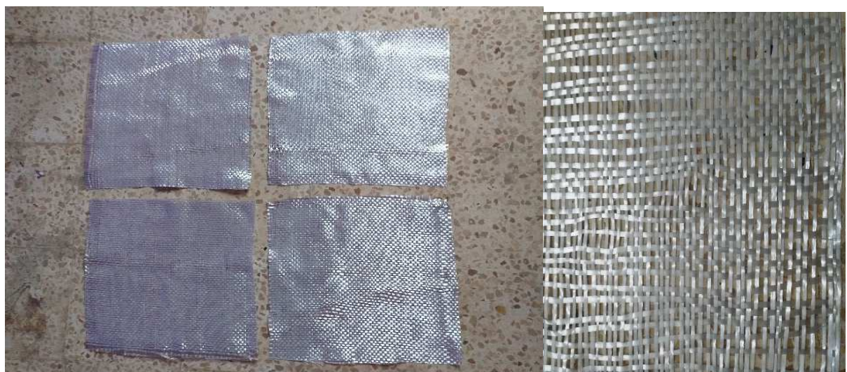
Figure III- 13 : Préparation de textile de verre avec ouverture des mailles de (3mm) puis l'enrober de résine
