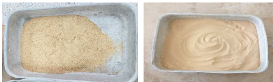
Figure III-2 : Sable de dune tamisé (0/2) après avoir été lavé et séché à l'étuve.
