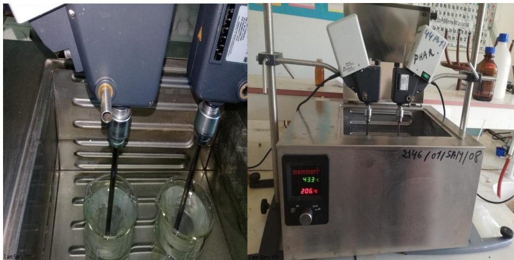
FigureN°11 : Montage pour test de dissolution.
