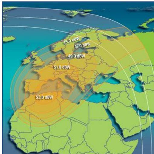
Figure 12 : INTELSAT IS901 342° EST (Bande Ku)
