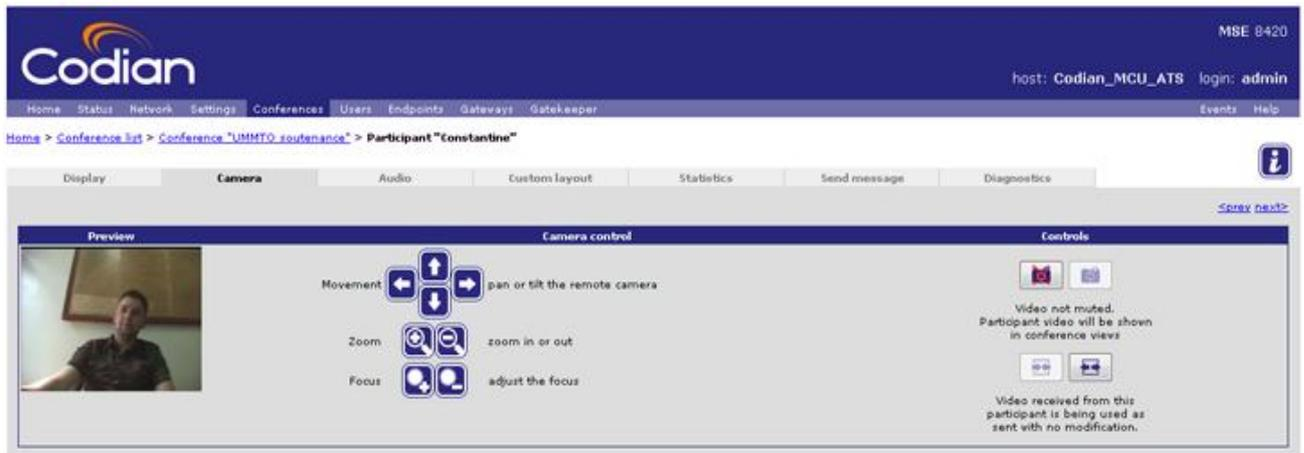
**Figure 37** : Fenêtre de gestion de la camera via le MCU.
