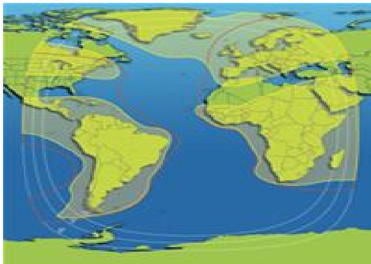
**Figure 12** : Couverture INTELSAT IS905 335° EST (Bande C)
