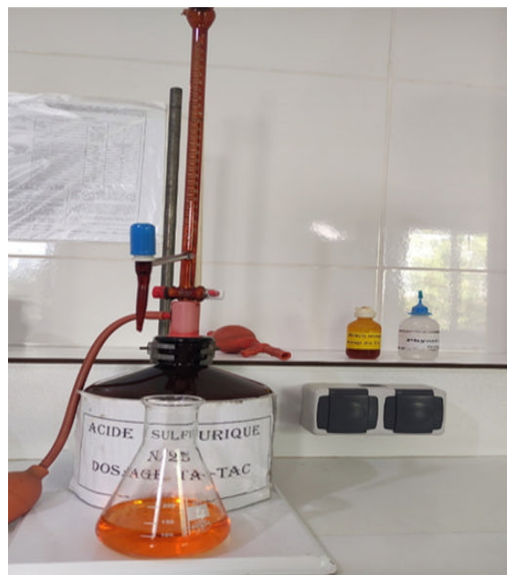
Figure 11 : Dosage de l'alcalinité (photographie originelle, 2023)
