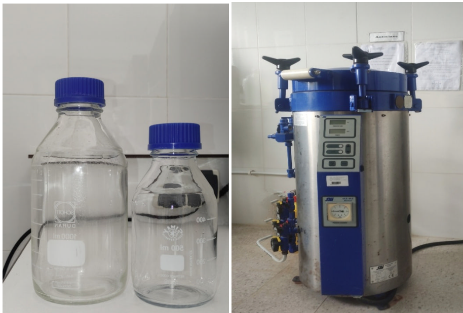
Figure 06 : Autoclave et flacons utilisés pour les prélèvements physicochimiques et bactériologiques (photographie originale, 2023)
