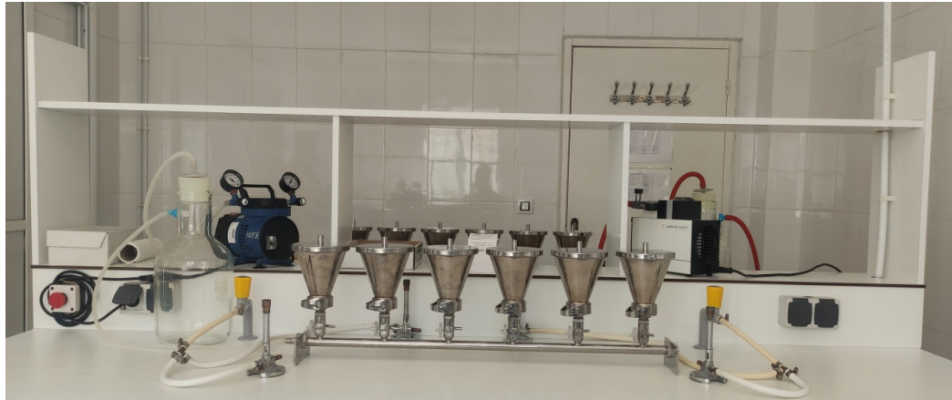
Figure 21 : Dénombrement des coliformes et Escherichia coli par la méthode solide (photographie originelle, 2023)
