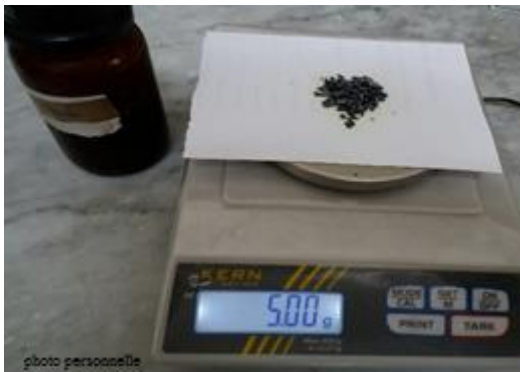
Figure 13 : Peser 5 g d'iode métalloïdique. Figure 14 : Peser 10 g d'iodure de potassium.
