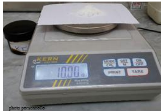
Figure 13 : Peser 5 g d'iode métalloïdique. Figure 14 : Peser 10 g d'iodure de potassium.
