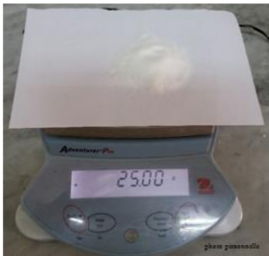
Figure 27 : Peser 25g de NaCl et diluer dans 100ml d'eau distillée.
