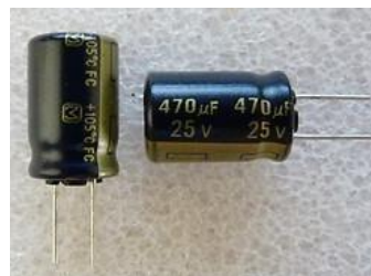
Figure 32. Condensateur électrolytique de tension nominale de 25V.
