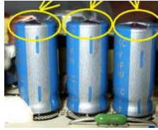
Figure 31. Condensateurs en pannes sont légèrement bombés (gonflés).
