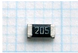
Figure 11. Résistance montée en surface CMS.
