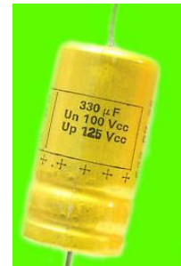
Figure 18. Tension U_n et U_p mentionnées sur un Condensateur SIC-SAFCO.
