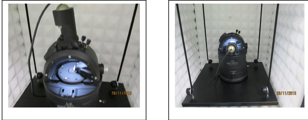
**Fig. 7.** Photographie de l'appareil de microscopie à force atomique (AFM).
