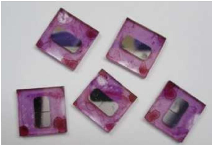
**Fig.30.** Photographie des transistors organiques BGTC avec P3HT couche active (violet) pour trois longueurs de canal 250,100 et 50 µm, l'isolant PVP et les électrodes en Argent.
