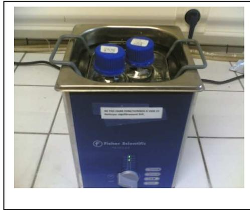
**Fig. 10.** Photographie de la cuve à ultrasons.
