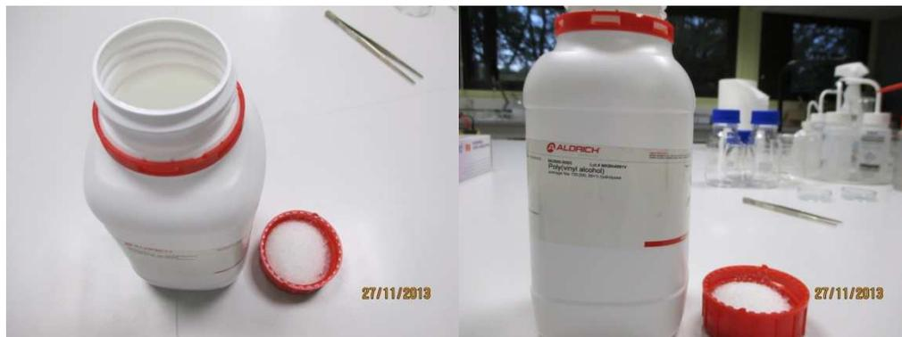
**Fig. 35.** Photographie de l'isolant Polyvinyl alcohol (PVA). Avec une masse molaire de 130.000 et une pureté de 99%.
