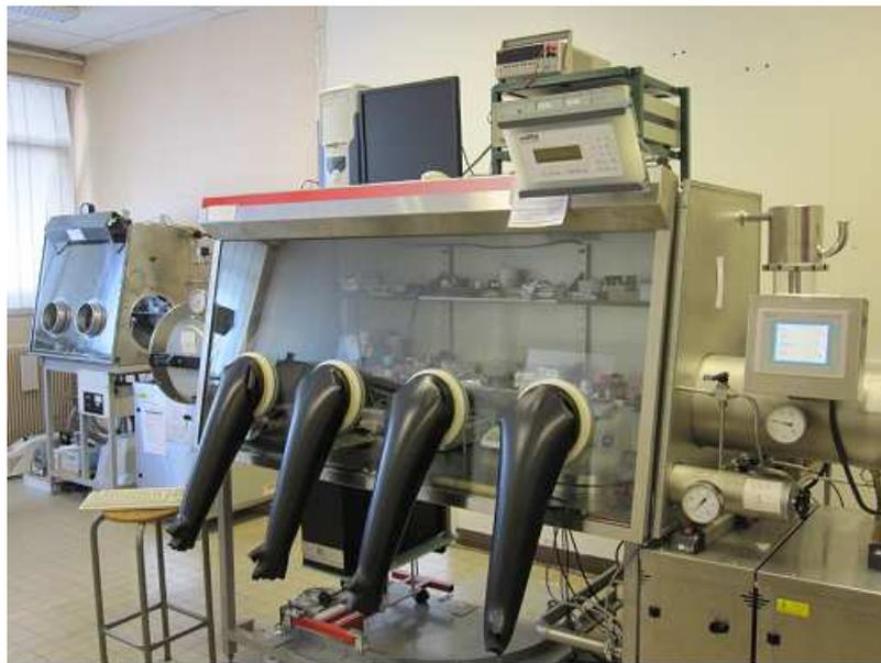
**Fig.28.** Photographie de la boîte à gants où l'on prépare la solution de P3HT et les composants réalisés à base des matériaux organiques sont protégés.
