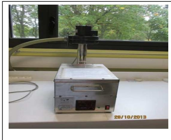
**Fig.11.** Photographie dispositif UV-ozone pour un meilleur nettoyage des échantillons.
