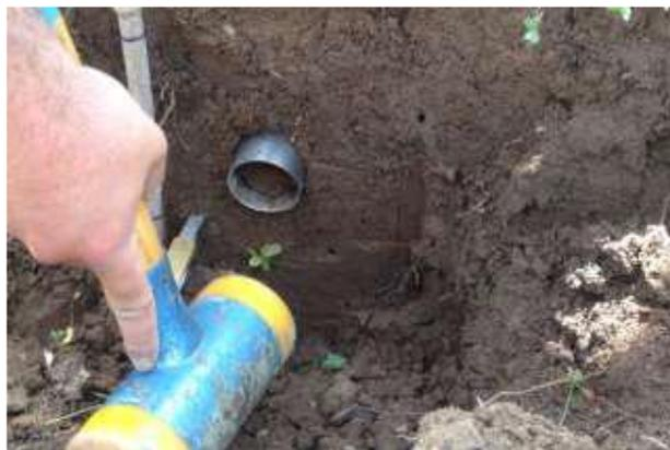
Figure 23. Prélèvement d'échantillon pour la détermination de la densité apparente.
