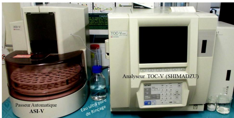
Figure 26. Analyseur TOC-V (SHIMADZU) couplé à un passeur d'échantillons ASI-V.
