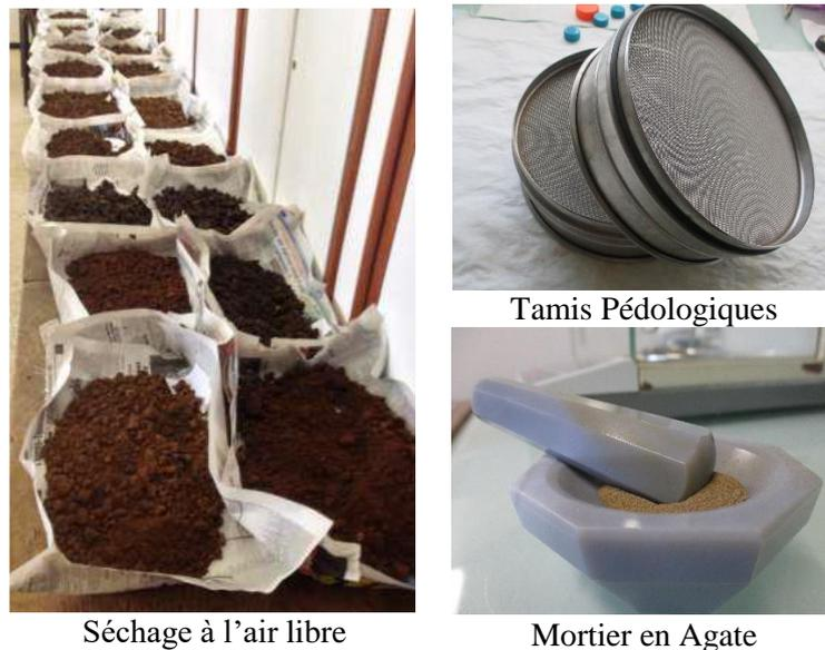
Figure 22. Prétraitements (séchage/tamisage) des échantillons de sols et de la boue.
