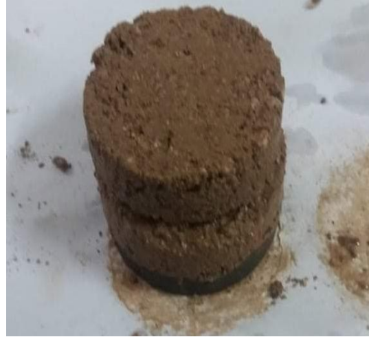
Figure 12.VI. Échantillon après cisaillement.
