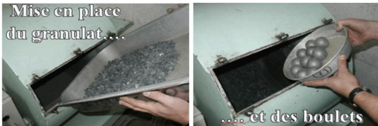
Figure 6.V. Mise en place des granulats pour l'essai Los Angeles.
