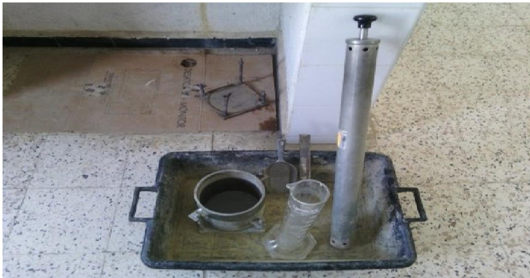
Figure 8.IV. Matériel utilisé pour l'essai Proctor.
