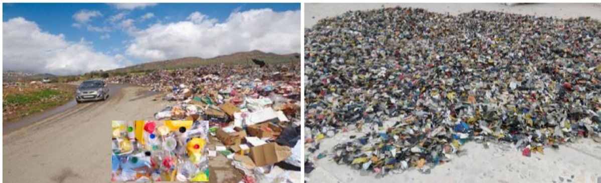
Figure 2.III. Déchets plastiques avant et après broyage.
