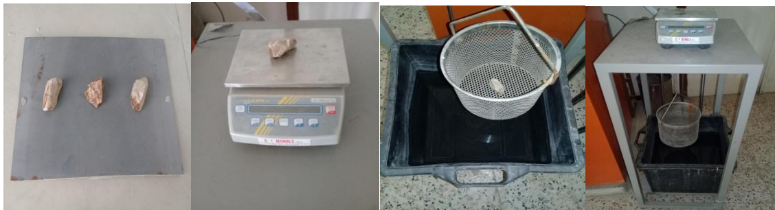
Figure 9.III. Etape de la pesée hydrostatique.
