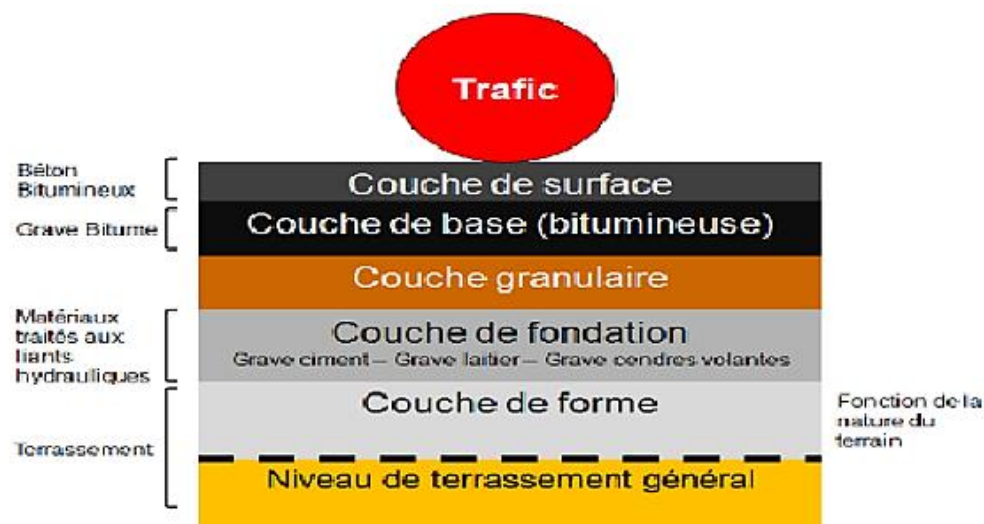
Figure 5.I. Structure type d'une chaussée inverse.
