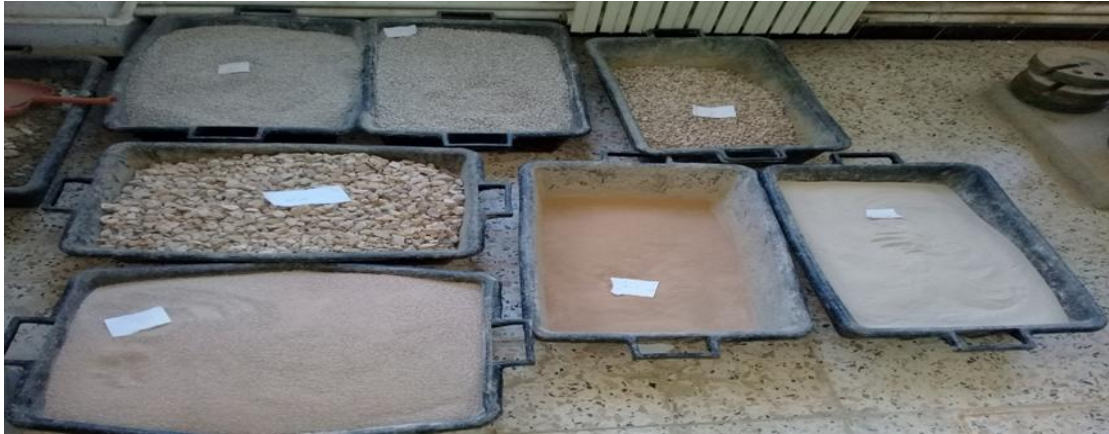
Figure 8.III. Classification de calcaire selon les différentes classes granulaires.
