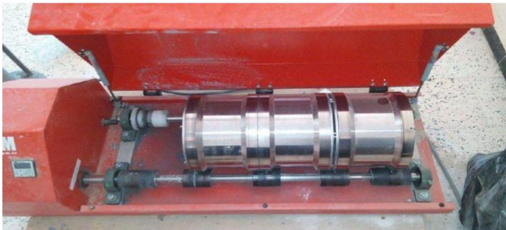
Figure 1.V. Machine d'essai Micro-Deval.
