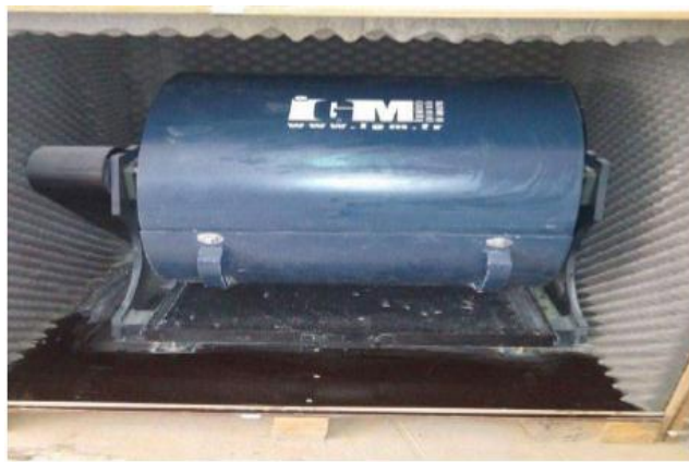
Figure 5.V. Machine d'essai Los Angeles.
