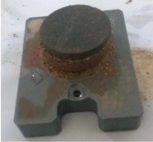
Figure 12.VI. Échantillon après cisaillement.
