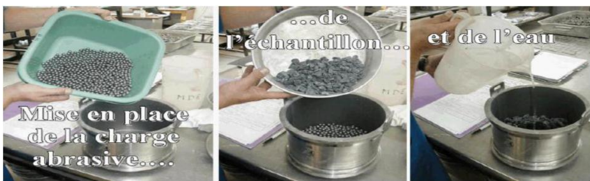
Figure 2.V. Mode opératoire d'essai micro Deval.
