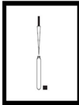
3. Ajouter 0,5 ml d'eau exempte de matière organique. Boucher et agiter vigoureusement pendant environ 30 secondes. Traiter ce blanc de réactif exactement comme l'échantillon, incluant la digestion et la mesure colorimétrique. Passer à l'étape 6.
