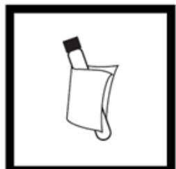
18. Essuyer avec un tissu propre l'extérieur du tube de réactif acide NT C contenant l'échantillon préparé.
