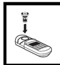
15. Placer l'adaptateur de tube DCO/TNT dans le puits de mesure en le tournant pour qu'il tombe en place. L'enfoncer pour qu'il soit correctement installé.
