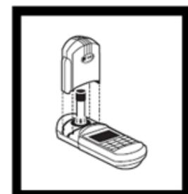
16. Lorsque le minuteur sonne, essuyer avec un tissu propre l'extérieur du tube de réactif acide NT C contenant le blanc de réactif. Placer le blanc dans l'adaptateur avec le logo Hach dirigé vers l'opérateur. Presser verticalement sur le haut du tube jusqu'à ce qu'il soit solidement en place dans l'adaptateur. Ajuster le capot de l'appareil pour couvrir le tube.
