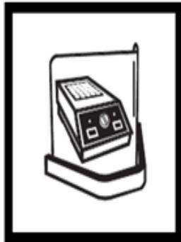
1. Allumer le réacteur DCO. Préchauffer à 103-106 °C (la température optimale est 105 °C). Placer l'écran de sécurité devant le réacteur.
