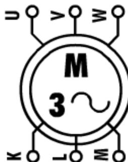
Figure I.18 : Moteur asynchrone à rotor bobiné (ou à bagues)
