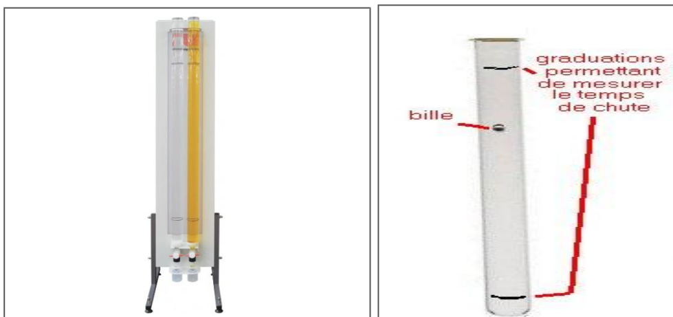
Figure 16: image accompagnée d'un dessin représentatif d'un viscosimètre.
