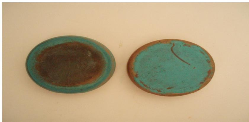
Fig.V.5. Formation d'humidité et oxyde de cuivre sur l'électrode
