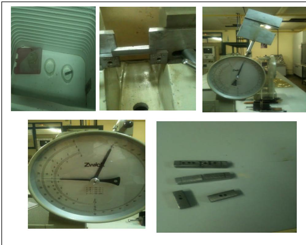
Figure 50 : images illustrant l'essai de résilience
