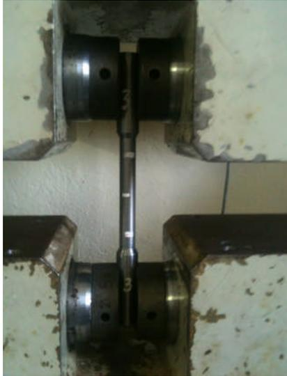
**Figure 44 : éprouvette entre les mors d'amarrage**
