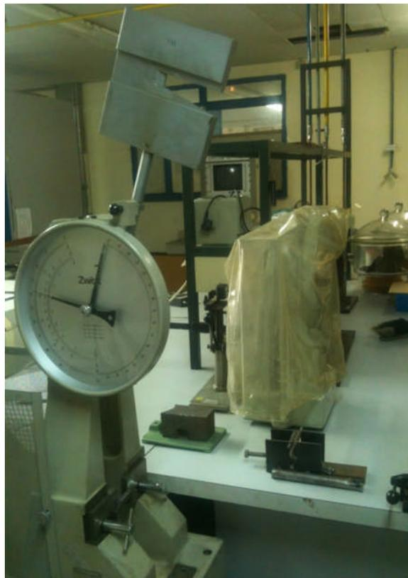
Figure 48 : machine d'essai de résilience (mouton pendule)
