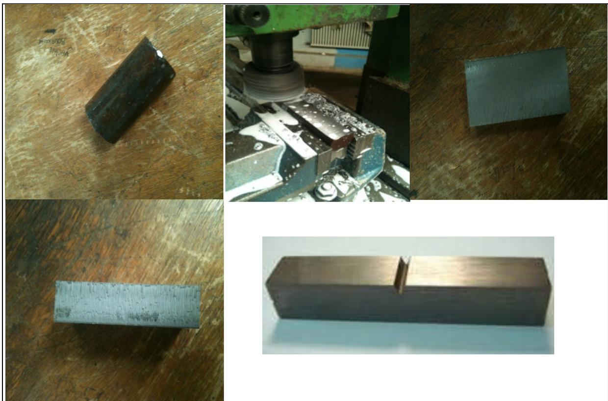
Figure 49 : Etapes de fabrication de l'éprouvette CHARPY V
