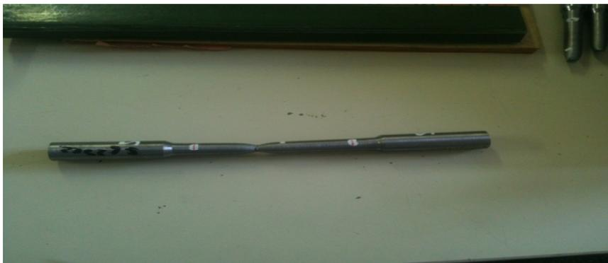
**Figure 45 : éprouvette de traction après rupture**
