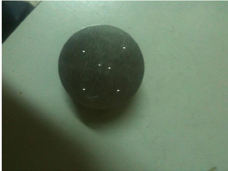
Figure 52 : échantillon utilisé pour le teste de dureté
