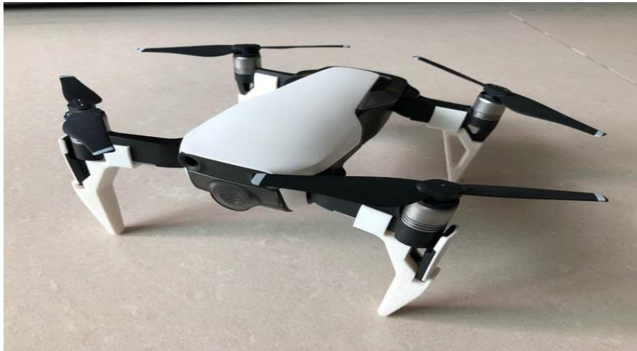
Figure 60 : Drone fabriqué en impression 3D.
