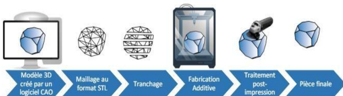
Figure 46 : Les différentes étapes de l'impression 3D [28].
