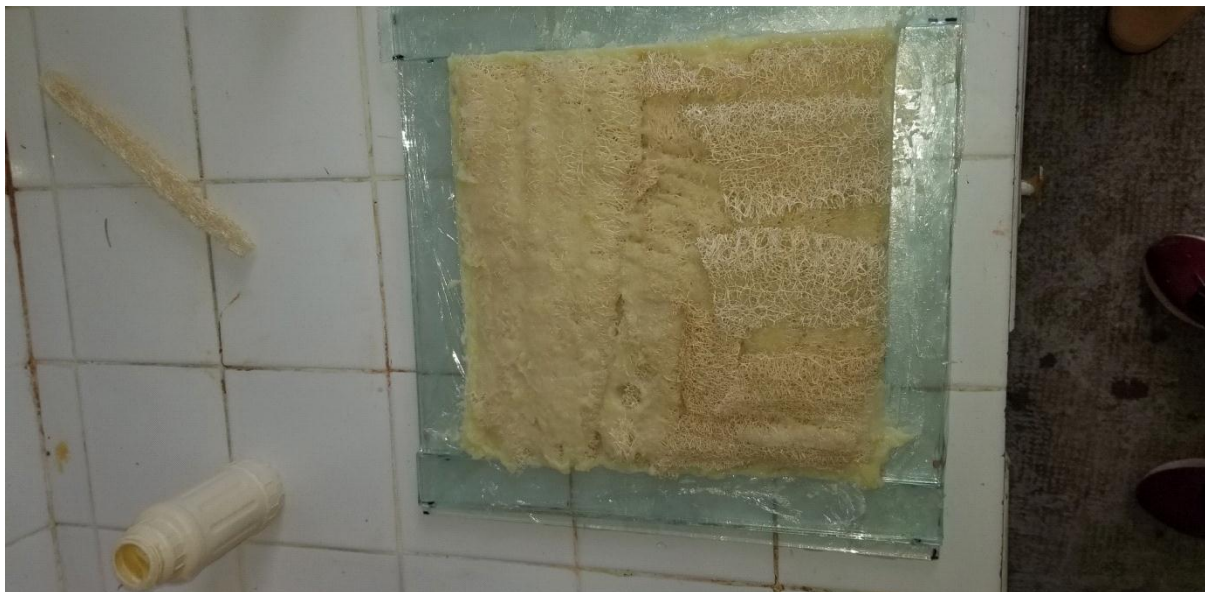
Figure IV-24 : Une seconde couche de fibres de courge de luffa est rajoutée dans le moule
