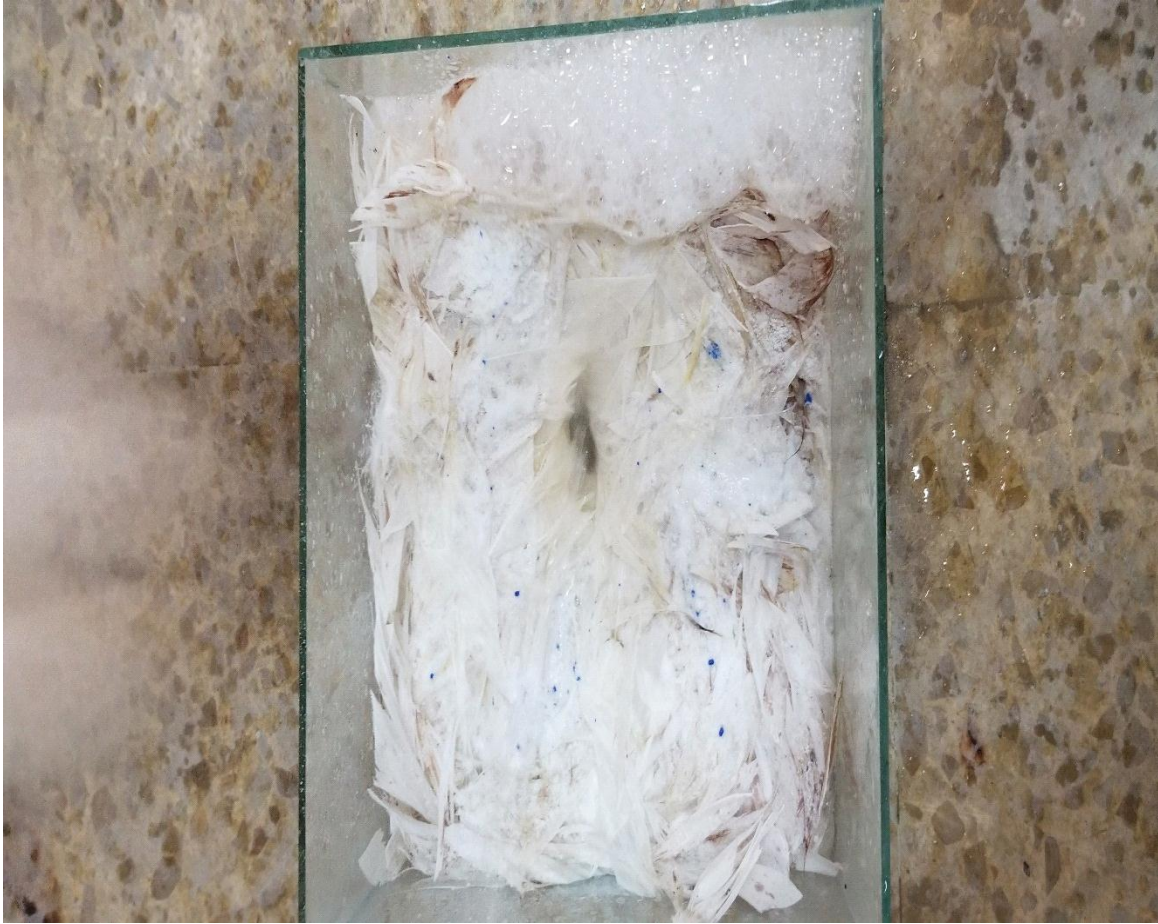
Figure IV-1 : Traitement des fibres avec des détergents et de l'eau chaude
