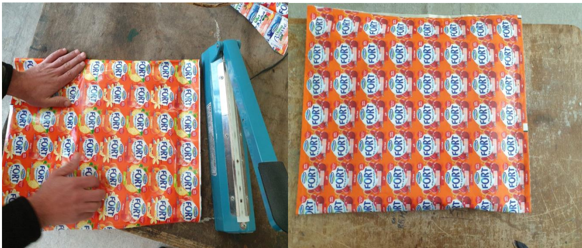
Figure IV.38 : Création d'une enveloppe en aluminium à l'aide d'une soudeuse
