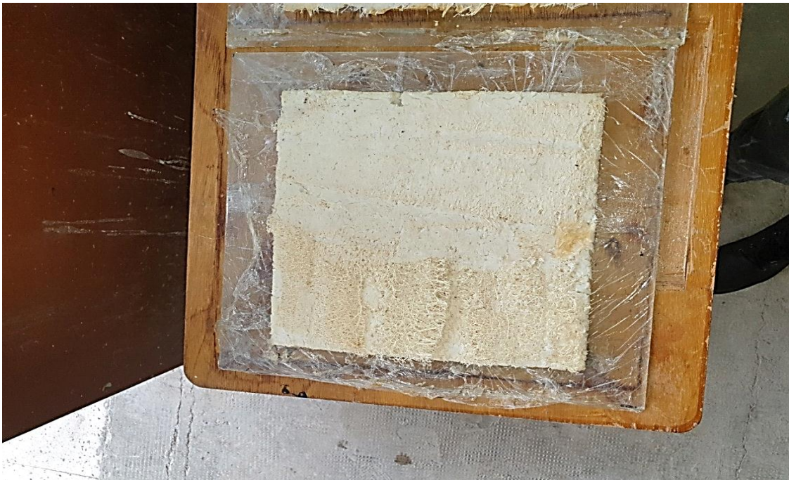
Figure IV-29 : La plaque fabriquée avec les fibres de luffa et la pâte de pomme de terre après le démoulage
