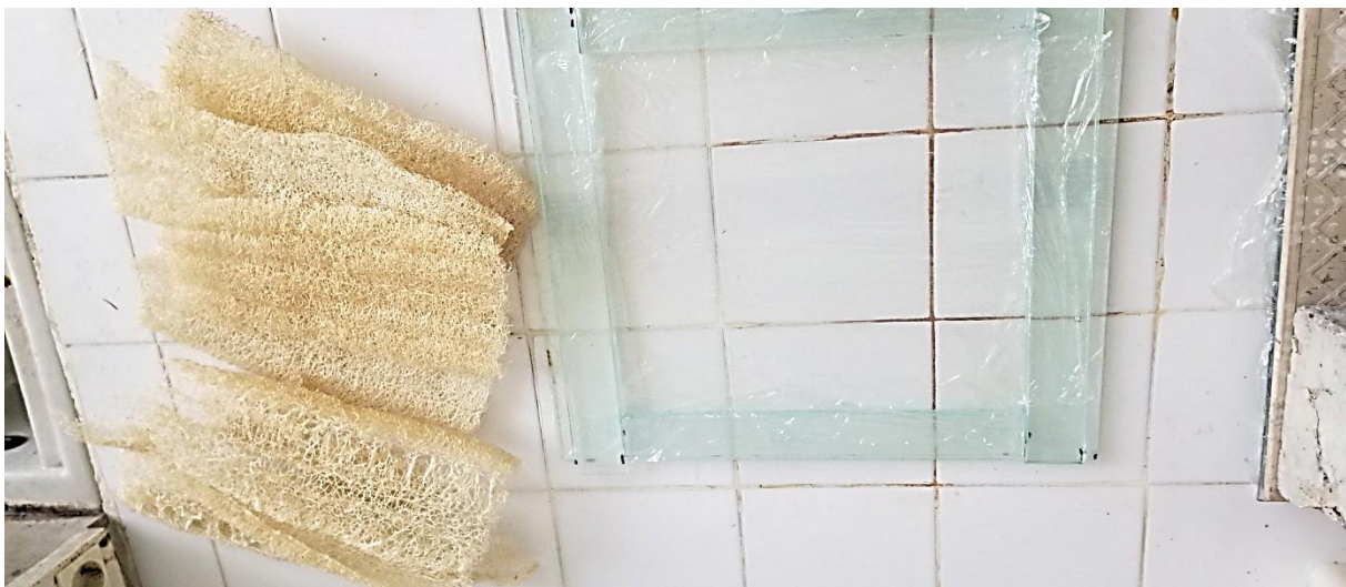
Figure IV-20 : Préparation du moule et des fibres de la courge de luffa en plaques
