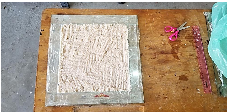
Figure IV-17: 1 ère Couche de pâte de riz d'une épaisseur de 0.4 cm
