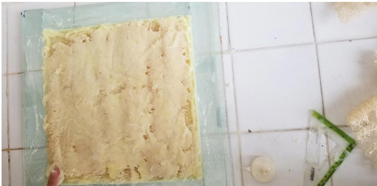
Figure IV-23 : A l'aide d'un outil, on rajoute une deuxième couche de pâte de faible épaisseur
