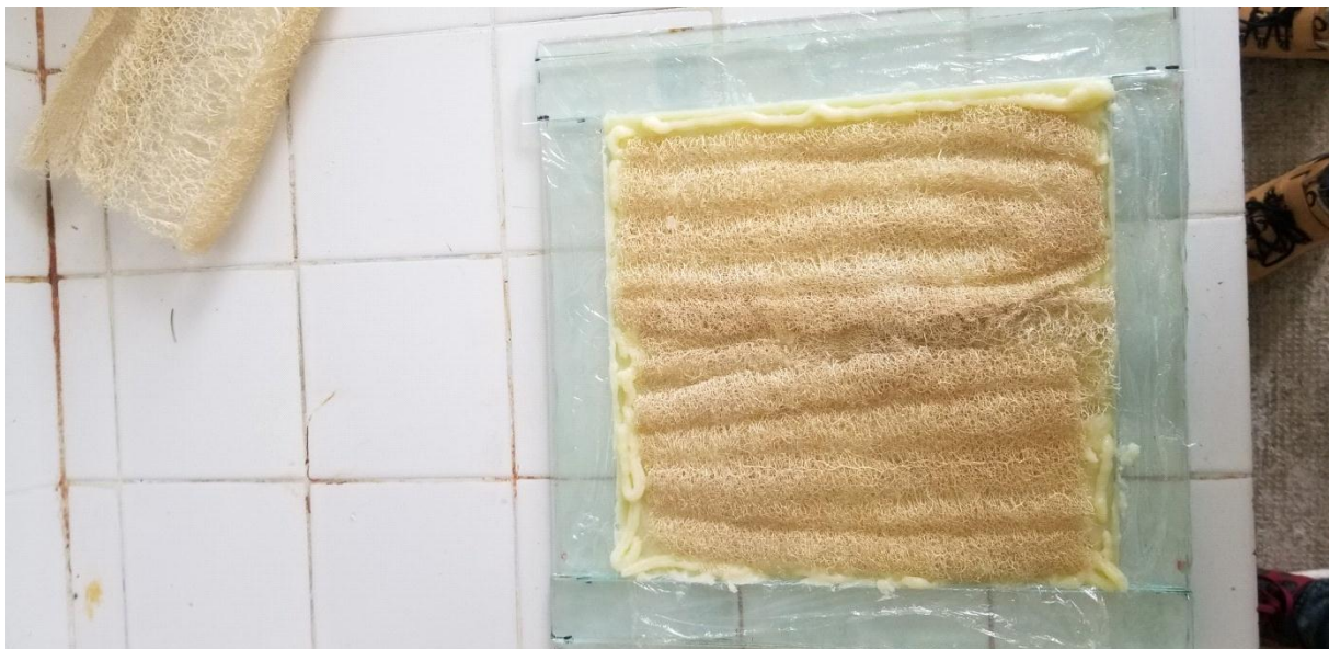
Figure IV-22 : Des plaques de fibres de la courge de luffa rajoutées sur la pâte
