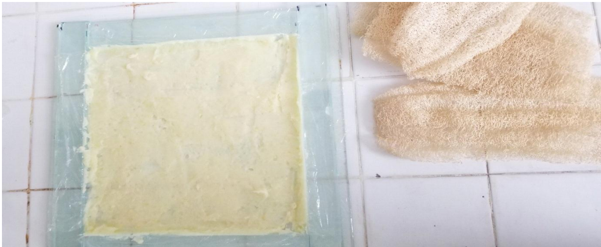
Figure IV-21 : La pâte de pomme de terre est ajoutée comme une première couche d'une épaisseur de 0.4 cm
