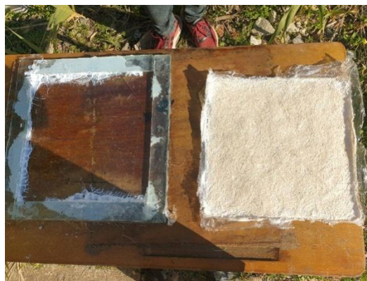
Figure IV.36 : la plaque de fibres de plumes de dinde avec la résine après le démoulage
