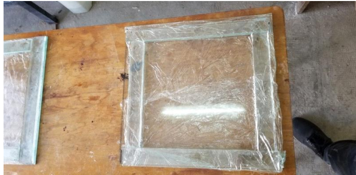
Figure IV-7 : Un moule en verre pour la réalisation des plaques de dimension (40 x 30 x 1,2 cm)
