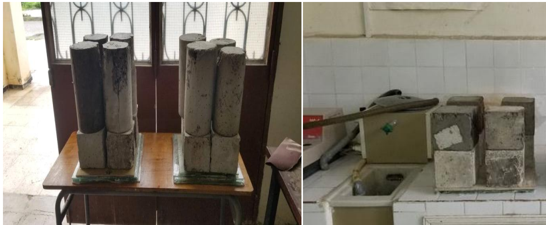
Figures IV-26 : Les moules remplis subissent une compression à l'aide des éprouvettes en béton
