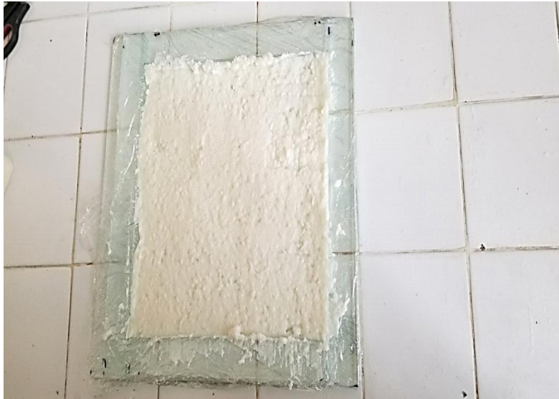
Figure IV-12 : Une couche de la paille de riz d'une épaisseur 0.4 cm
