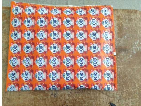
Figure IV.37 : Plaque d'isolant enveloppée par la feuille d'aluminium
