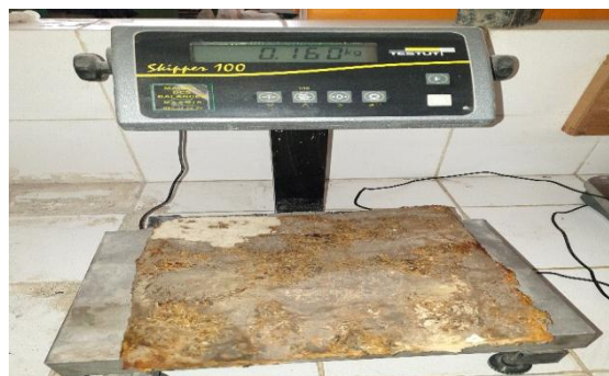
Figure IV.31 : Balance électronique utilisée pour mesurer la perte de poids des plaques
