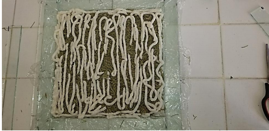
Figure IV-14 : Une couche de la patte de riz injectée à l'aide d'un outil sur les fibres de lavande
