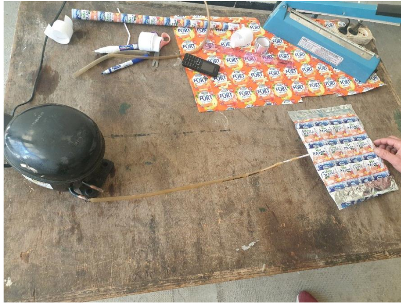
Figure IV.39 : l'aspiration de l'air qui se trouve dans le matériau à l'aide d'une pompe à vide
