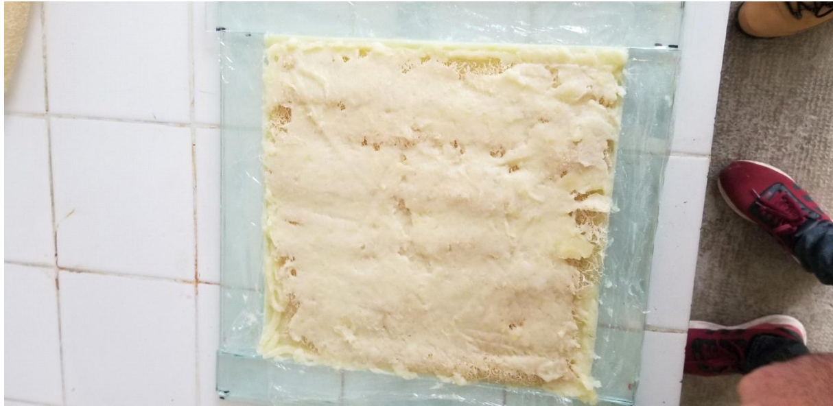
Figure IV-25 : Enfin, une dernière couche est ajoutée sur les fibres avant de fermer le moule par son couvert
