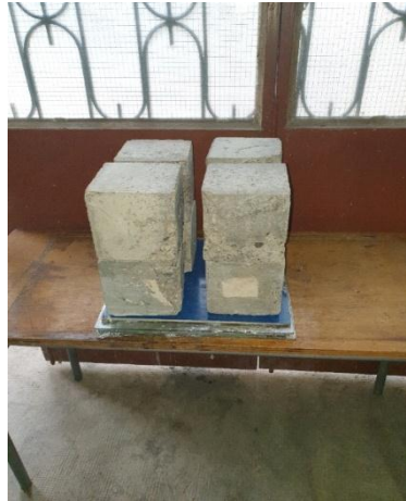
Figure IV.35 : Les moules remplis subissent une compression à l'aide des éprouvettes en béton
