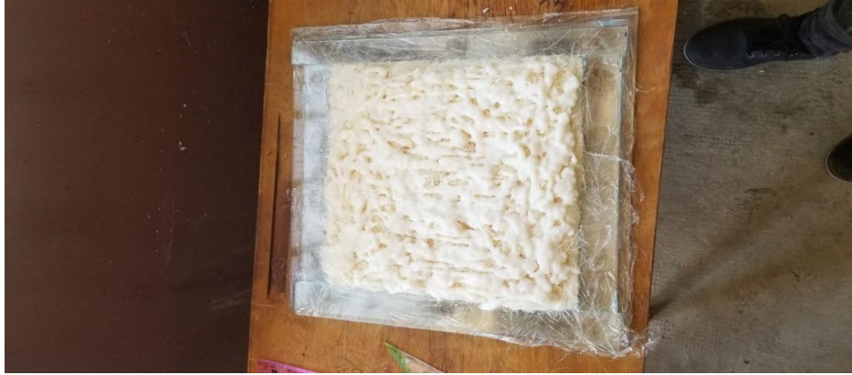
Figure IV-19 : Pâte de riz injectée sur les fibres à l'aide d'un outil
