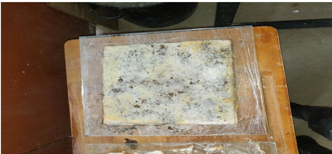
Figure IV-27 : La plaque constituée de fibres de lavande et la pâte de riz après le démoulage
