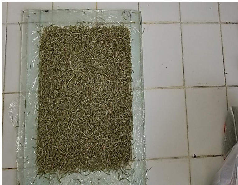
Figure IV-13 : Une couche de fibres de lavande rajoutée directement sur la paille d'une épaisseur d'environ 0.8 cm
