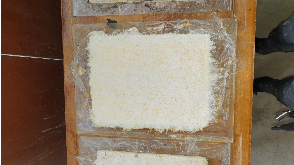
Figure IV-28 : La plaque fabriquée avec les fibres de dindes et la pâte de riz après le démoulage
