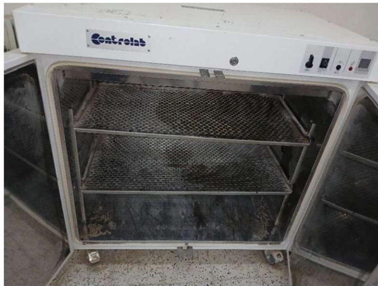
Figure III-5 : L'étuve utilisée pour le séchage des granulats.
