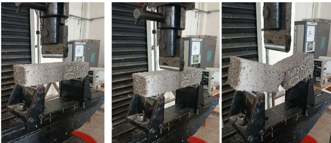
Figure III-25 : Dispositif expérimental pour l'essai de traction par flexion 3 points.
