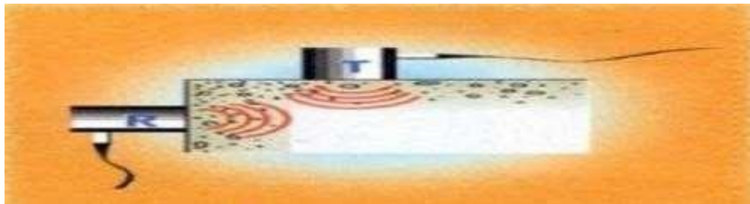
Figure III-21 : Mesures semi directe.
