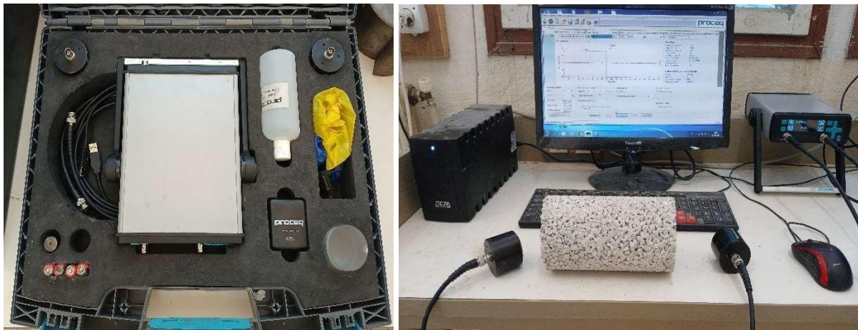
Figure III-23 : Appareil PUNDIT pour mesure de la vitesse de propagation des ondes.
