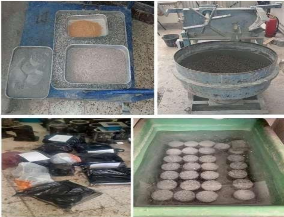
Figure III-16 : Les différentes étapes de fabrication et conservation des éprouvettes.
