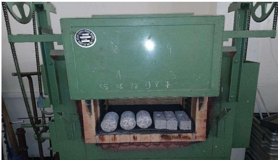
Figure III-19 : Disposition des éprouvettes à l'intérieur du four.
