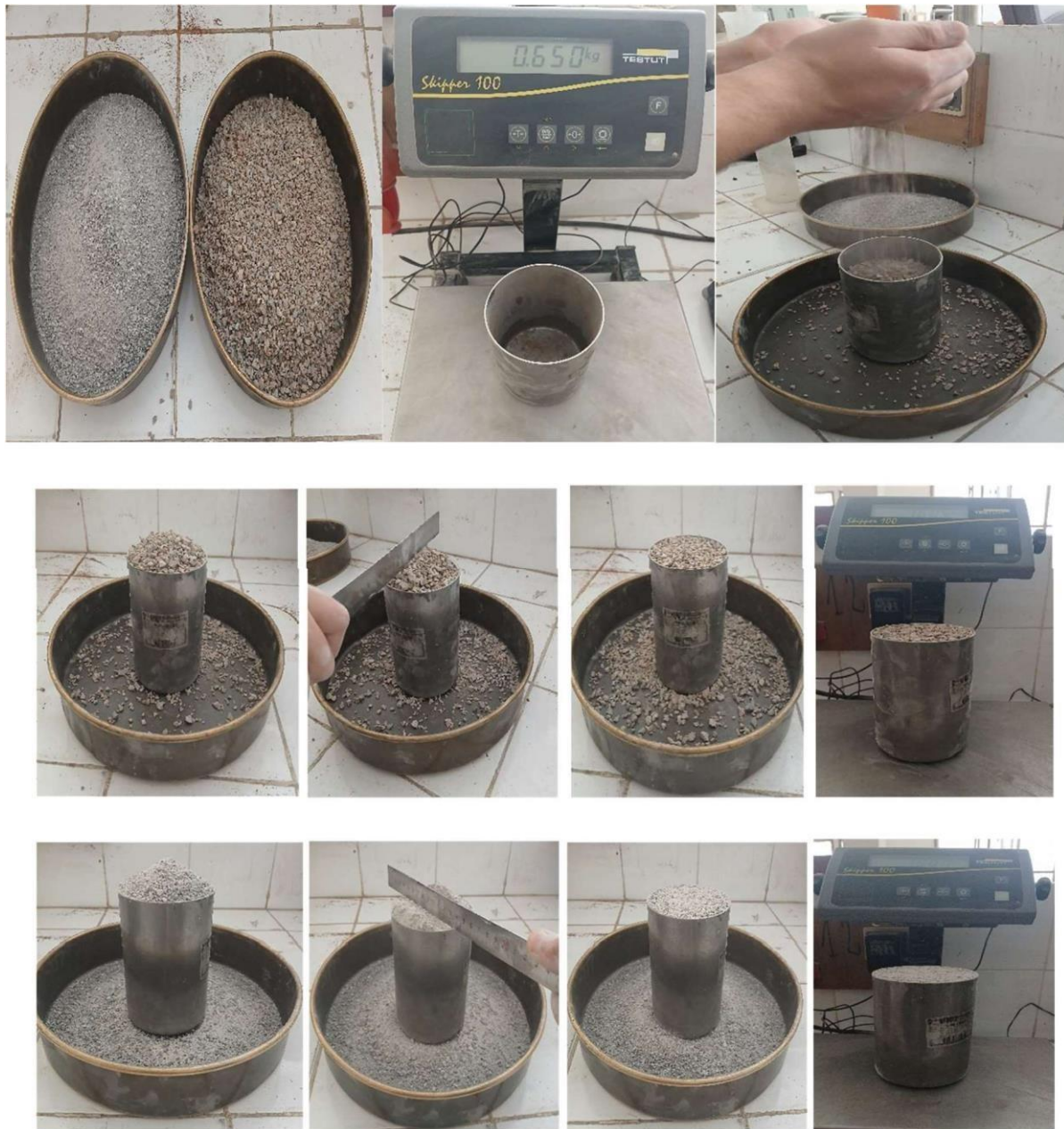
Figure III-10 : Mesure de la masse volumique apparente du sable et gravier.
