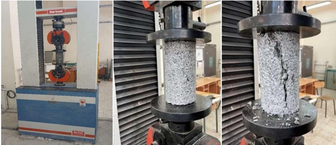
Figure III-24 : Dispositif expérimental pour l'essai de compression.
