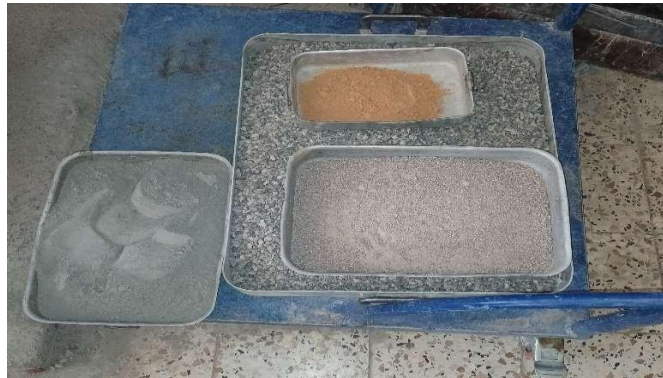
Figure III-14 : Préparation des pesées pour la confection des bétons étudiés.
