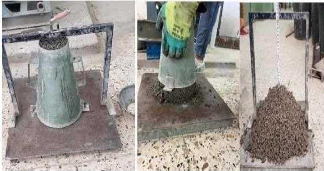
Figure III-17 : Les étapes de l'essai au cône d'Abrams.
