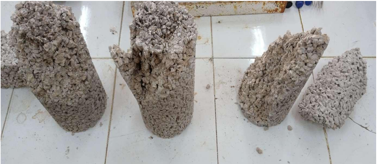
Figure IV-7 : Aspect des éprouvettes cylindriques après rupture.
