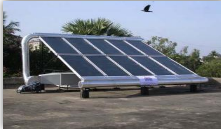
Figure 20 : une pilote de séchage solaire (Energypedia, 2021).
