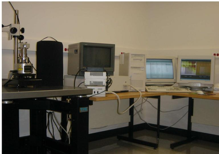
**Fig. II-21** Microscope à force atomique NanoScope IIIa [VEECO](#)
