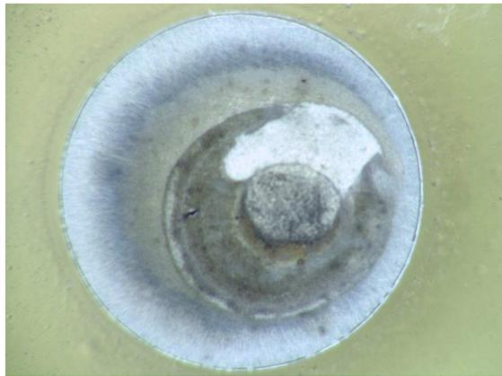
**Fig. IV-34** Observation optique de la surface du Fe36Ni / 150  $\mu\text{m}$   $\text{H}_2\text{SO}_4+\text{Na}_2\text{SO}_4$   $t_{im}= 38$  h
