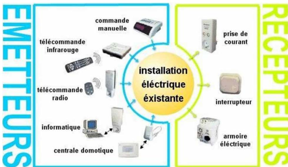
*Figure II.2 : Technologie courant porteur en ligne.*
