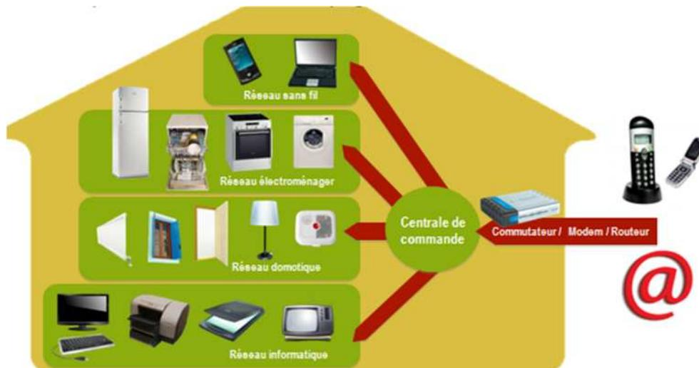
*Figure I.2 : Schéma de communication avec la centrale domotique.*
