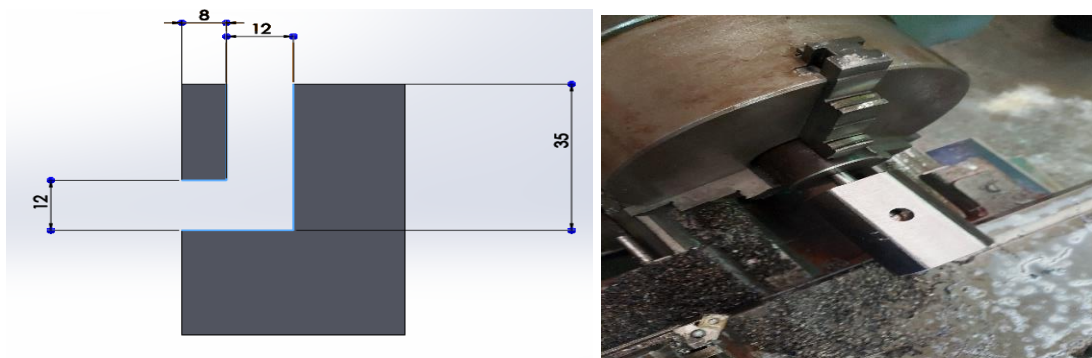
Figure V.6 : Plan de coup et dimension de la filière.
