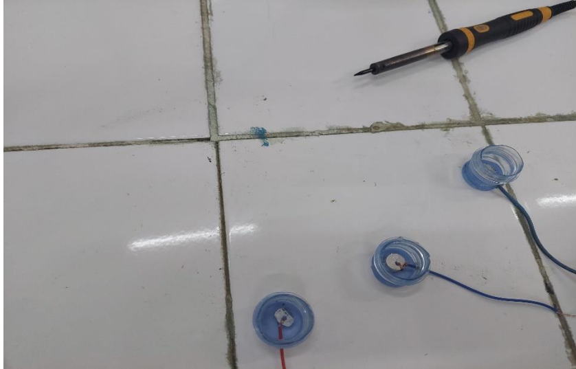
Figure V.12 : Procédure de d'enrobage des échantillons.
