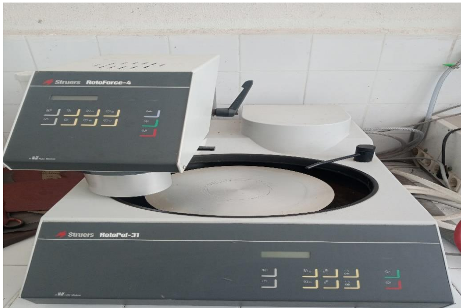
Figure V.14: La machine utilisée pour le polissage des échantillons.
