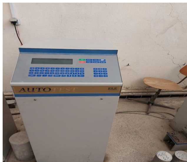
Figure V.10 : La partie de manipulation commande de la presse.
