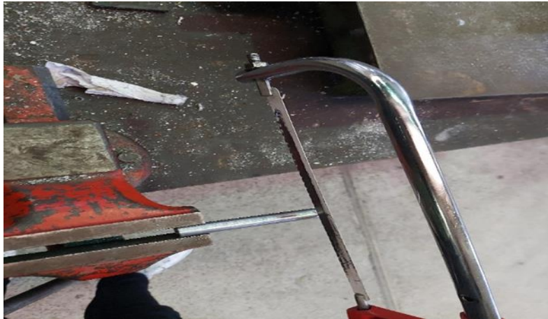
Figure V.12: Découpage des éprouvettes à l'aide d'une scie à métaux.
