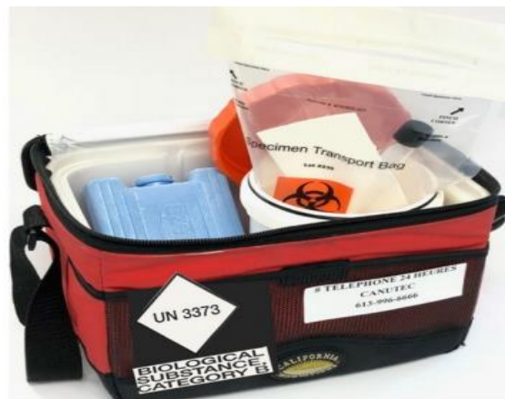
Figure 7: Triple emballage pour le transport des échantillons biologiques(42).
