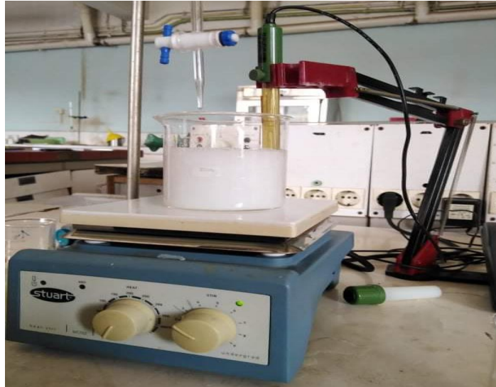
Figure III.1. Montage expérimental de la préparation de l'HDL Mg-Al-CO 3 (Drici, 2015)
