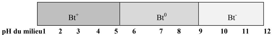
**Figure V-4 : Variation de la charge de surface de la bentonite à différents pH de solution.**
