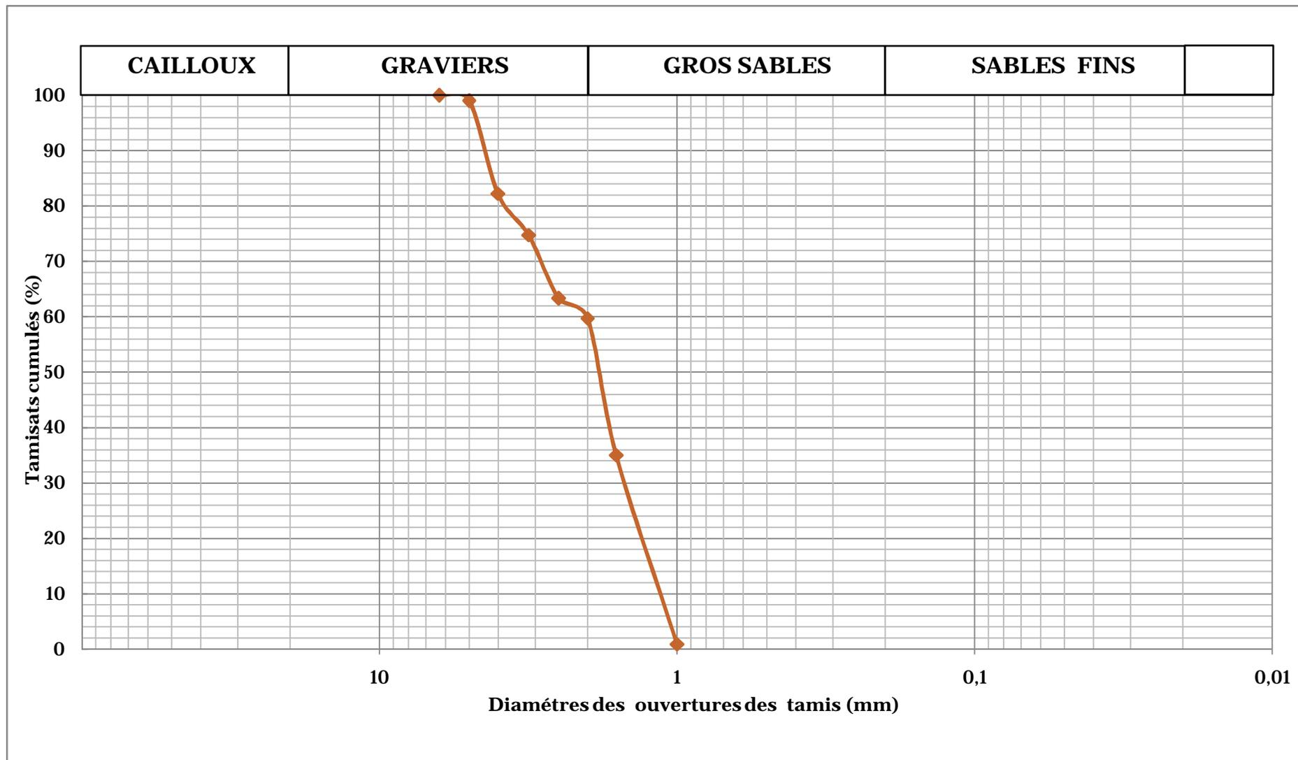
Figure(V.2) : Courbe granulométrique de calcaire.
