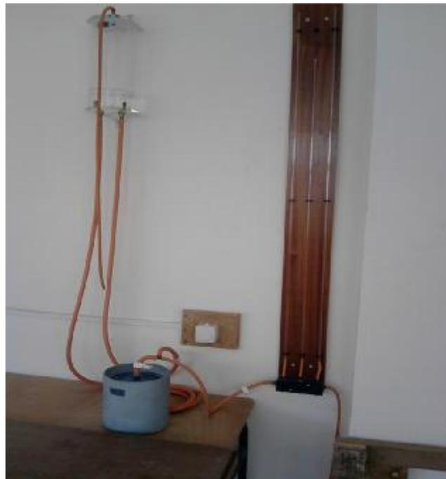
**-Le dispositif de l'essai de perméabilité-**
