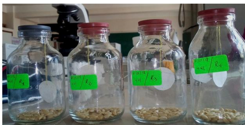
Figure 14 : Dispositif expérimental du test d'inhalation des huiles essentielles de romarin et de menthe poivrée à l'égard des adultes de R. dominica (ORIGINALE, 2018).
