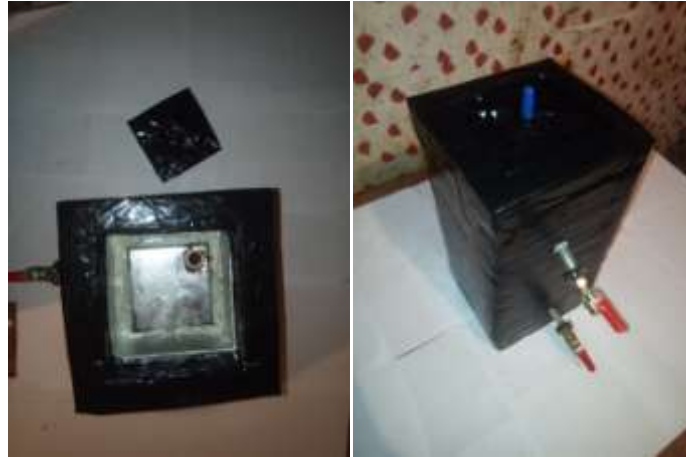
Figure III.1: Le module de stockage thermique
