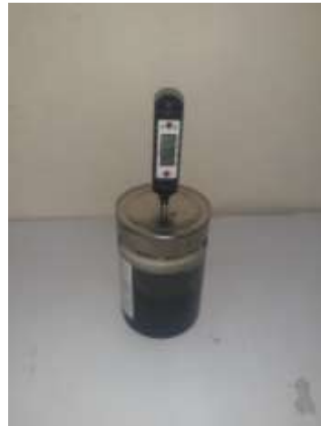
Figure III.13 : Température de fusion de MCP utilisé
