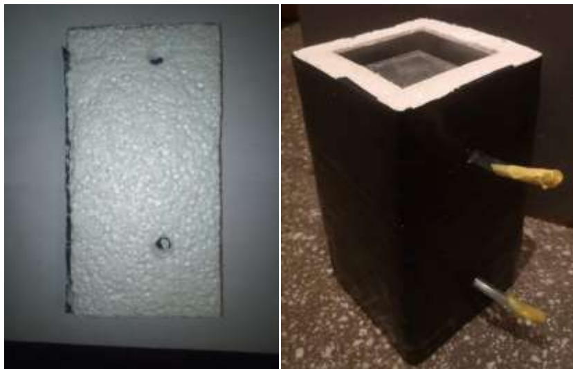
Figure III.15 : L'isolation avec du polyester
