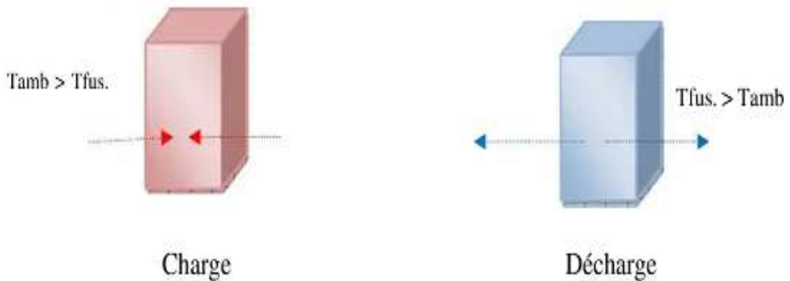
Figure. I.6 : Schéma représentatif de charge et décharge d'un MCP [11]
