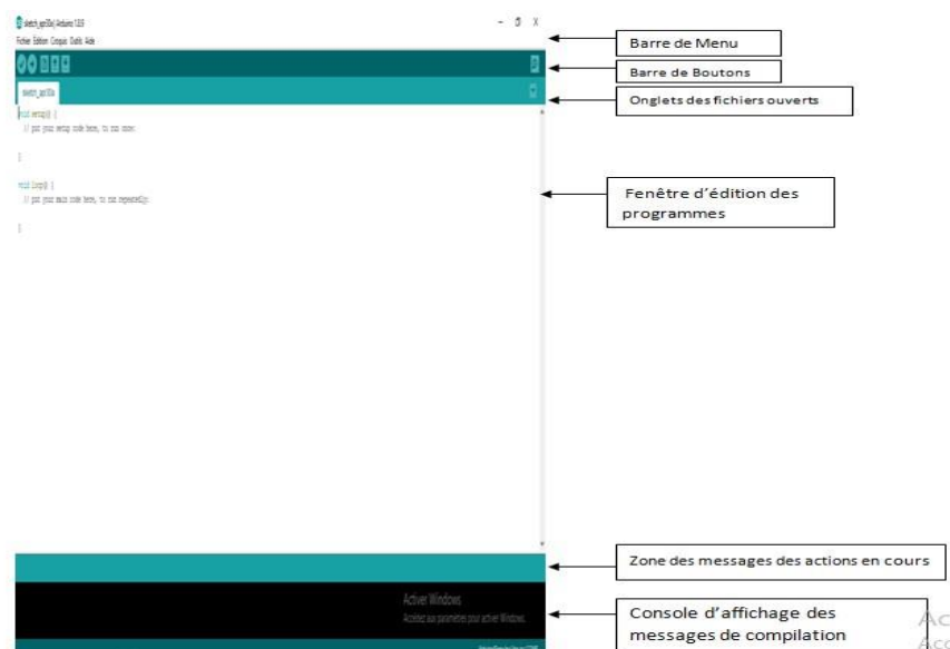
Figure II.27: Présentation de la fenêtre principale du logiciel Arduino.
