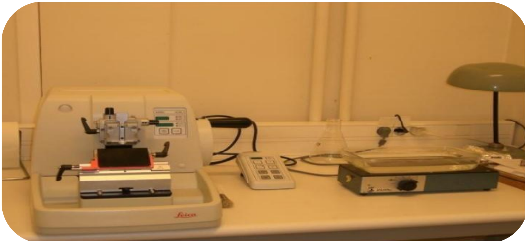
Figure 23: Dispositif permettant de faire des coupes : microtome à gauche et bain Marie à droite.
