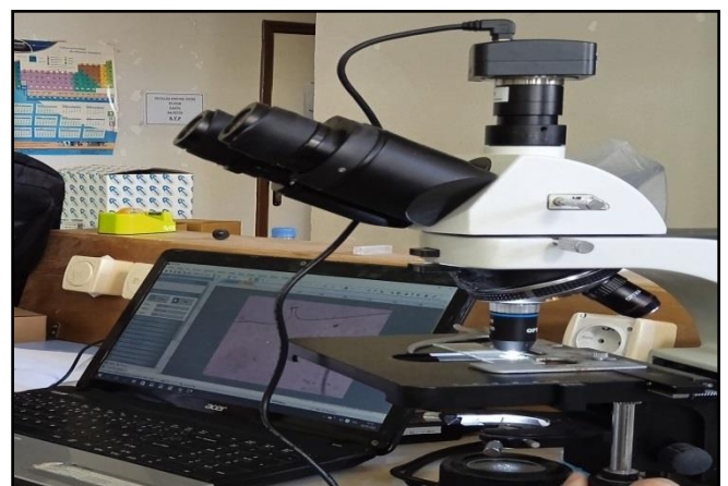
Figure 16 : image illustrative du microscope photonique connecté à l'ordinateur et l'outil de la caméra.
