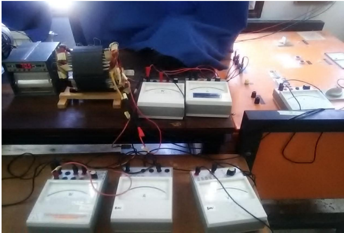
Figure III.14 : Photo du banc d'essai pour mesuré les pertes fers
