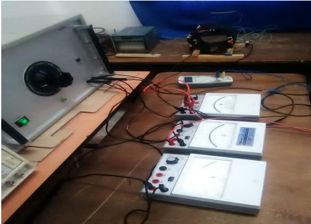
Figure III.11 : Photo du banc d’essai pour mesuré les pertes fers
