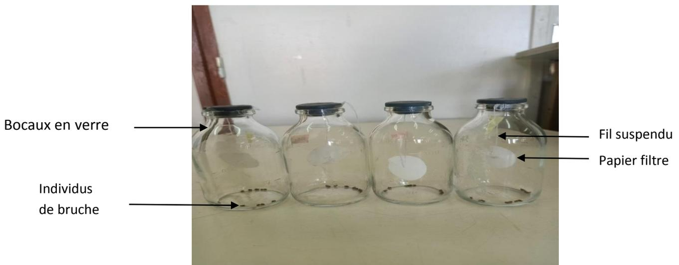
**Figure 16.** Dispositif expérimental du test d'inhalation de l'huile essentielle utilisée à l'égard des adultes de *C. maculatus* (Originale, 2019).
