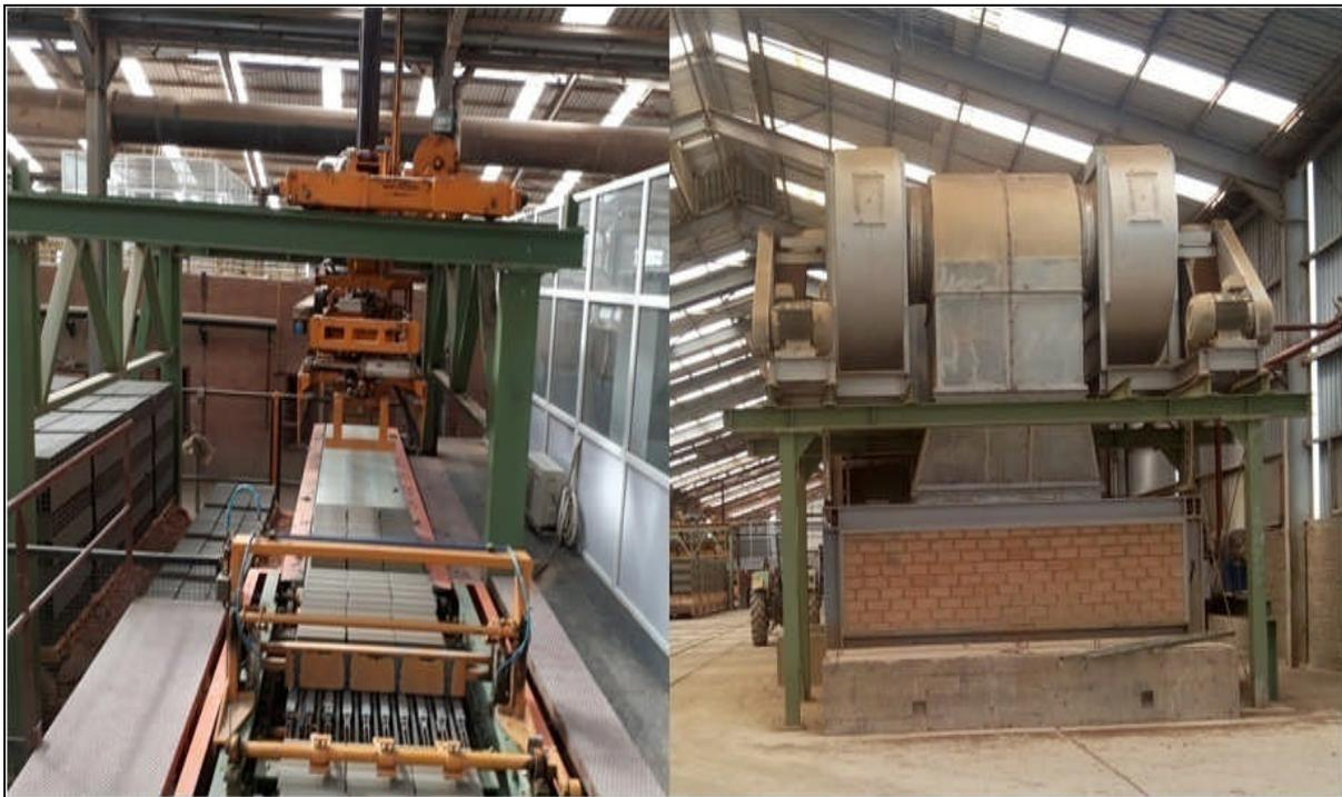
Figure V-19 : Le séchoir de la zone de production.
