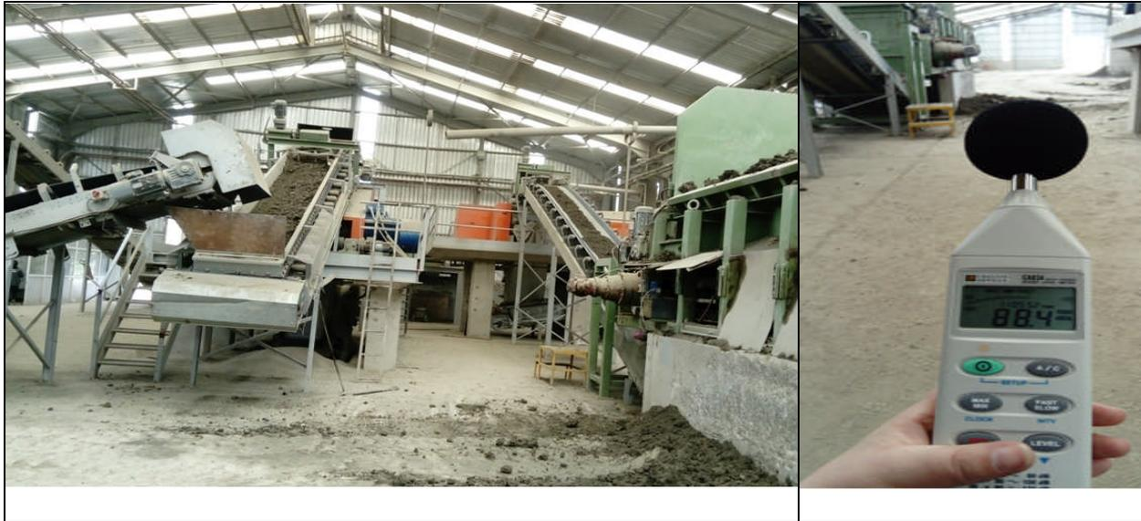
Figure V-12 : Niveau de bruit dans la zone de préparation de la matière première.
