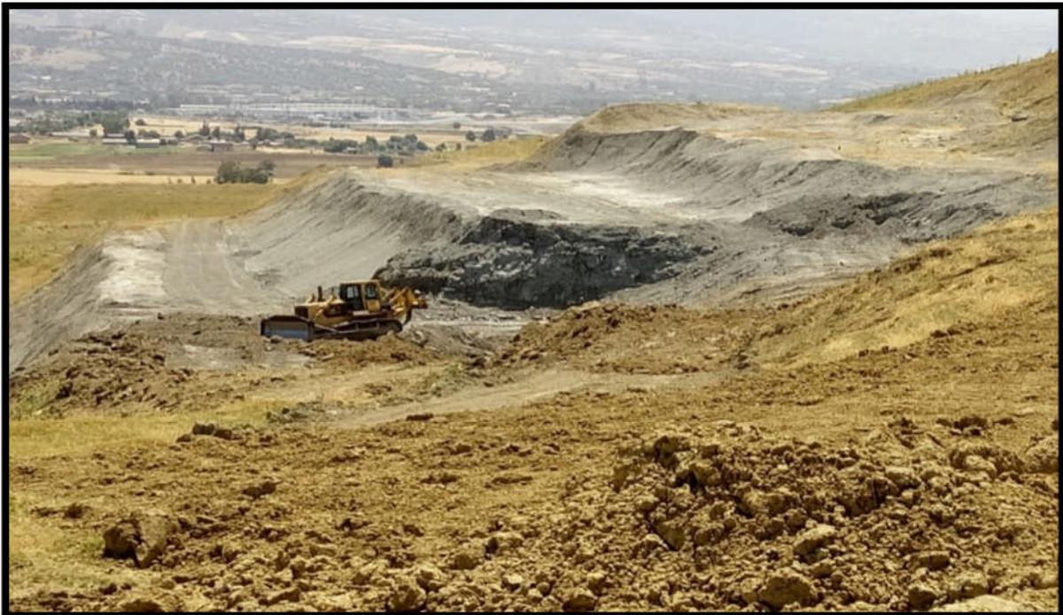
Figure V-3 : Exploitation à ciel ouvert du gisement d'argile de Freha.
