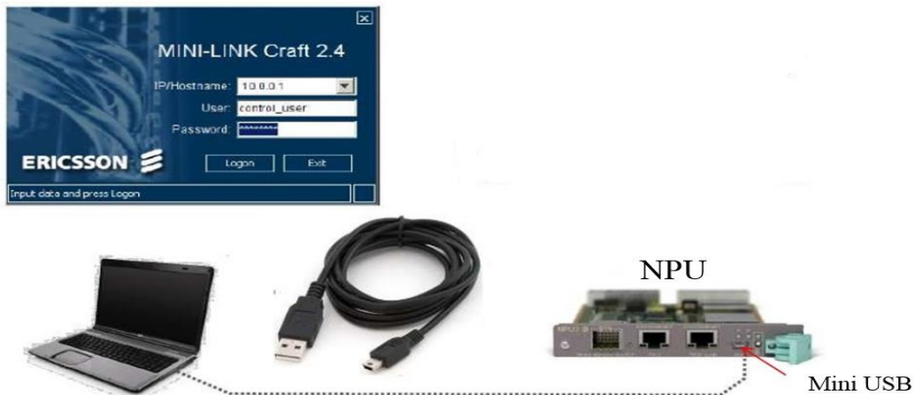
Figure III.24 : Les éléments d’une configuration radio.
