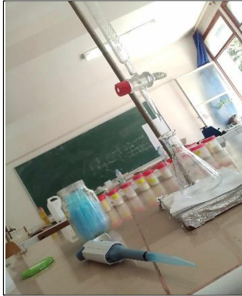
Figure 20 : Titrage acido-basique pour la mesure de l'acidité titrable ( D^\circ ).
