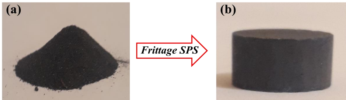
Figure IV.1 : Photographie de l'échantillon, (a) : la poudre Mg_2Si avant frittage, (b) : l'échantillon obtenu après le frittage SPS.
