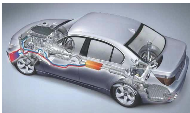
Figure I.113 : Conception d'un générateur thermoélectrique produisant de l'électricité de la chaleur perdue au niveau du pot d'échappement d'un véhicule.
