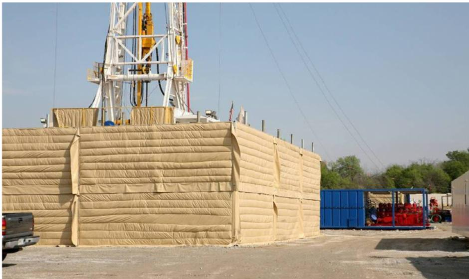
**Figure 4.9 :** Un rig enrobé pour limiter le bruit généré par le forage ou la fracturation hydraulique [12]
