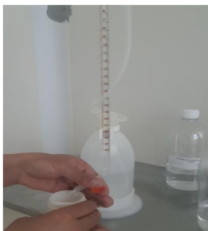
Figure 17: dosage de l'acidité titrable
