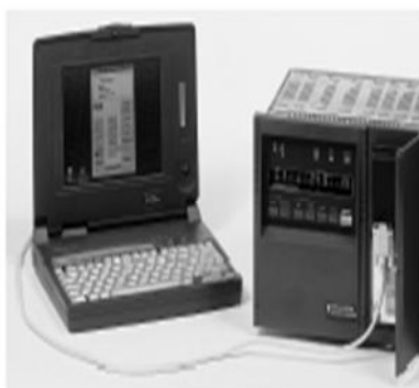
Figure IV.9 : Installation de SFT 2801 avec le PC [16]
