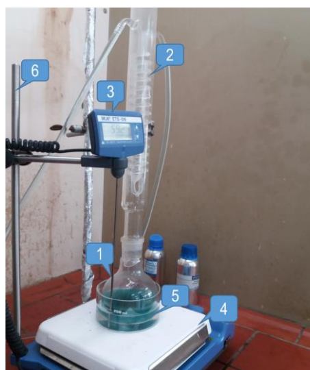
Figure II. 1 : Montage expérimental pour la synthèse de nanoparticules
