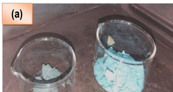
Figure II.5 : L'étape de séchage et le broyage de la poudre.
