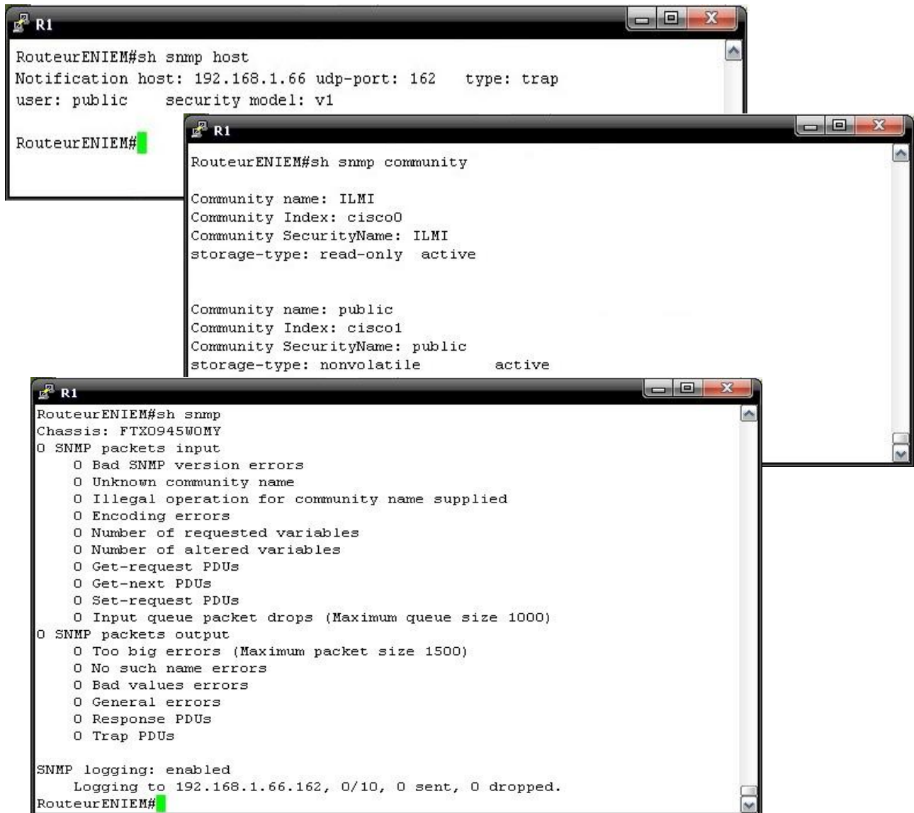
Figure V.46 : Vérification de la bonne configuration des agents SNMP d'équipements
